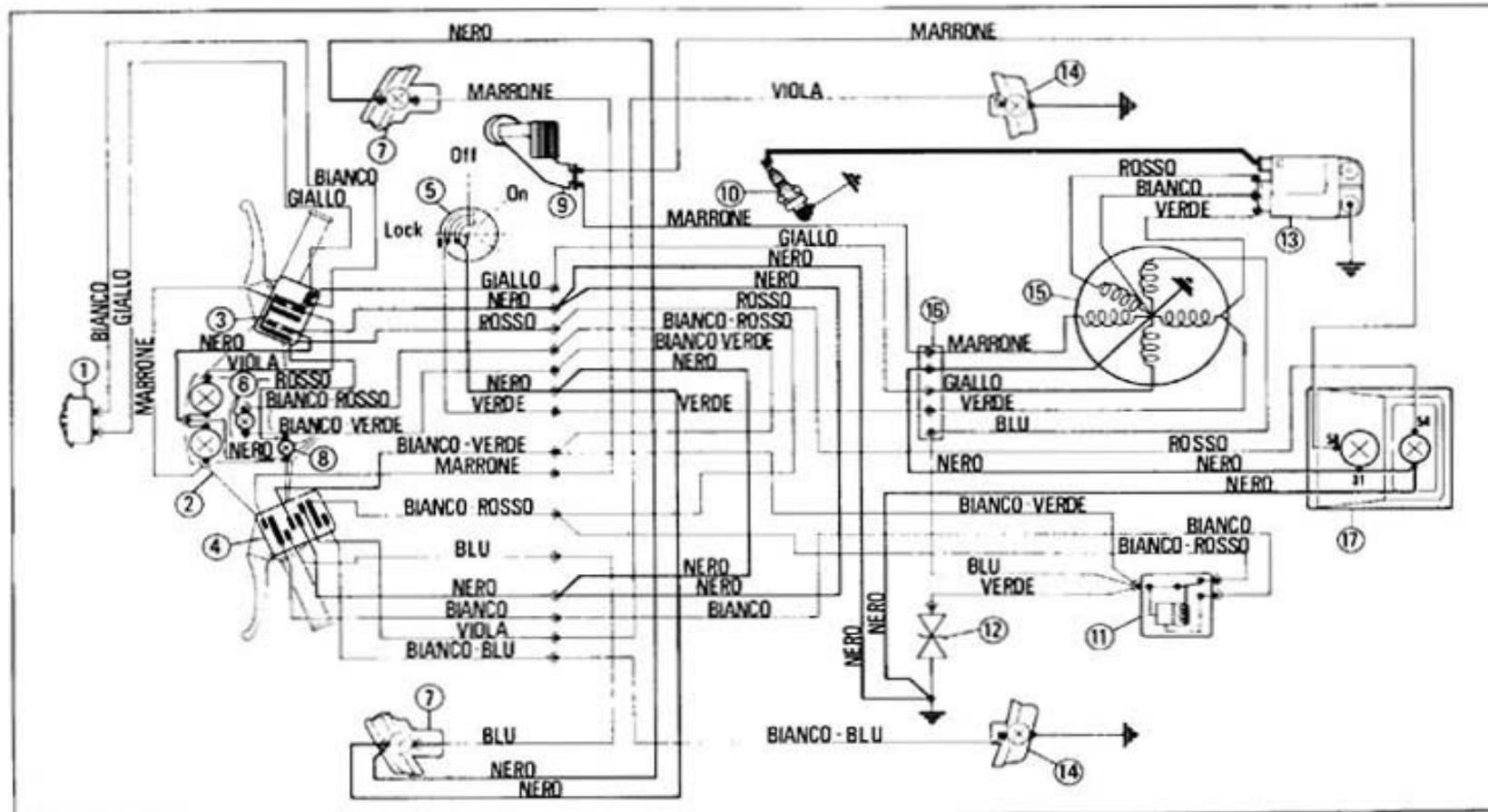
1. Hupe – 2. Scheinwerfer (Begrenzungslicht 6V–15W, Abblendlicht 6V–15W) – 3. Lichtumschalter – 4. Blinkerumschalter – 5. Zündschloß – 6. Blinkeranzeige (12V–1,2W Lampe) – 7. Blinker, vorne (12V–10W Lampen) – 8. Tachobeleuchtungs-lampe (12V–1,2W) – 9. Bremslicht-
